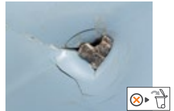
• Ślady uderzeń na skorupie i złamany zaczep
