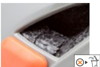
• Pęknięta skorupa wewnętrzna
