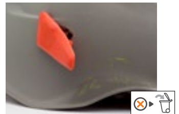
• Ślady uderzeń na skorupie i złamany zaczep
