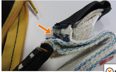
• Absorber został obciążony dynamicznie, szwy absorbujące zostały naruszone
